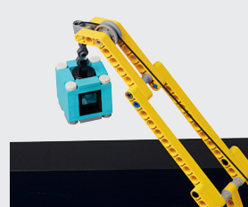
Stap 2: Haak deze blauwe unit vast en wind deze helemaal naar boven op tot aan het geleidegat. Draai de arm volledig met de klok mee.
